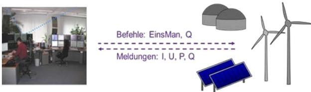
Abbildung 4 Bidirektionale Verbindung zwischen Netzleitstelle und Erzeugungsanlagen mittels Fernwirktechnik
